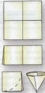
Рис. 13. Изготовление фильтра
